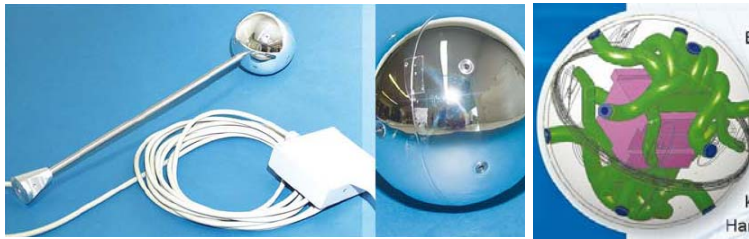
Figure 11 : Capteur de mesure du système de mesure 3D
