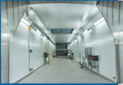
▲ Chambre climatique ATP pour essai de véhicules frigorifiques.
